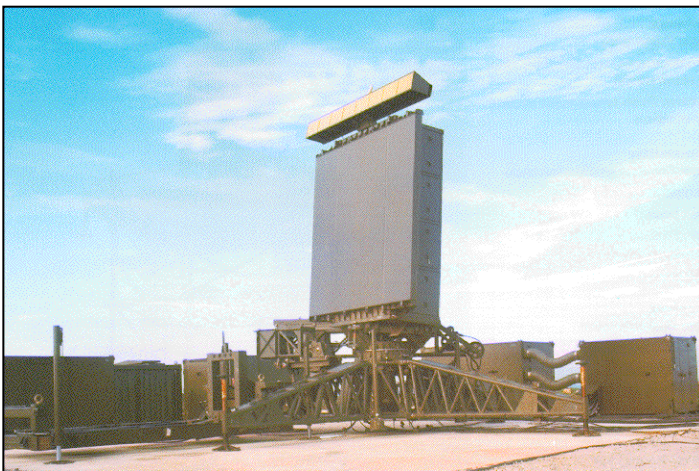
12. ábra. RAT–31 távelfelderítő (3D) radar (mobil, szállítható változata)
