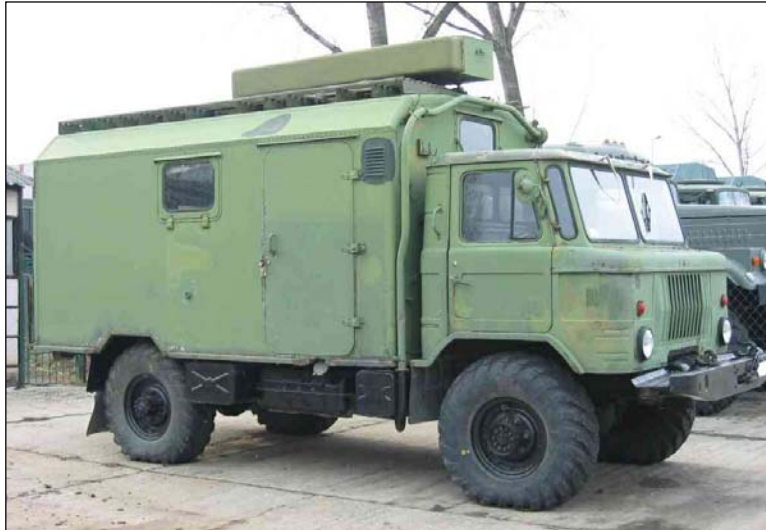
16. ábra. Az RPSz-6 rádiótechnikai felderítő állomás (menethelyzetben)
