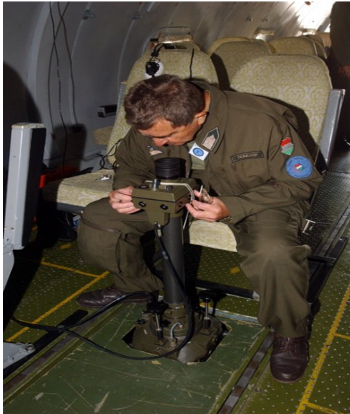
Az AN-26T fedélzetéről végrehajtott megfigyelő repülésérzékelő műszerének kezelője
