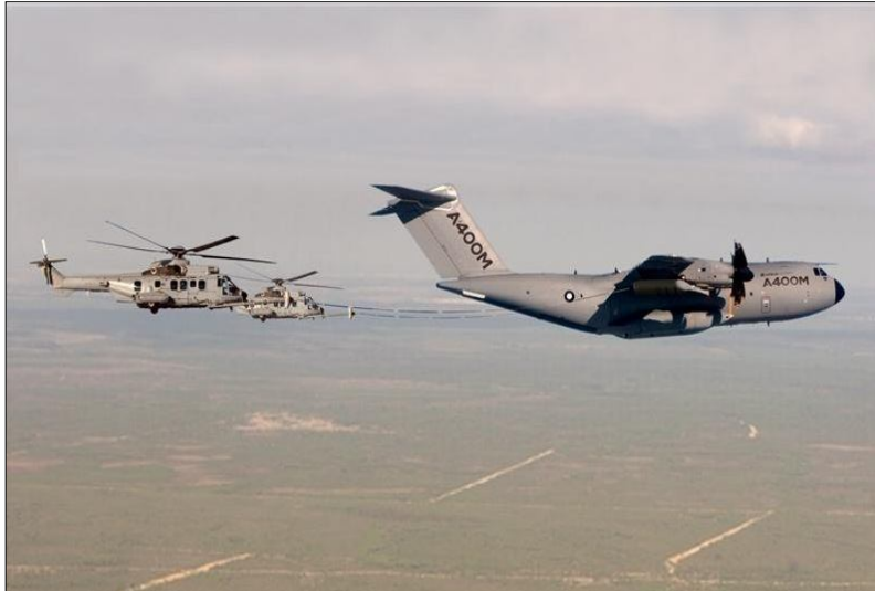
27. kép. Példa egy új, kettős képesség kialakítására. Az Airbus A400 légi utántöltő repülőgép, amely stratégiai légi szállításra is alkalmas 145
