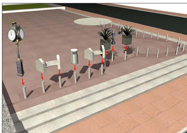
7. ábra. Utcabútorok alá rejtett oszloprendszer 41
