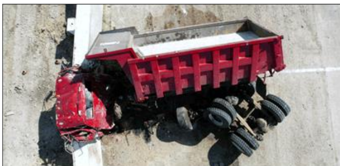
5. ábra. A térdfal és a teherautó teszt előtti és utáni állapotban 39
