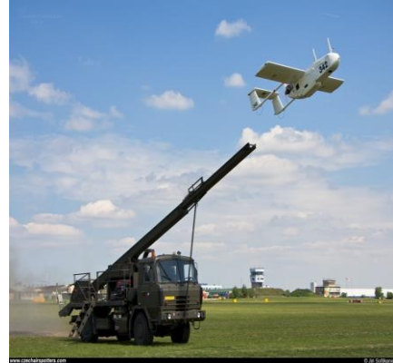
8. kép: Sojka UAV indítása katapulttal 28
