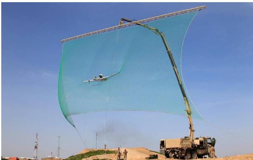
11. kép: Bundeswehr LUNA drón landolása elfogó hálóval 33
