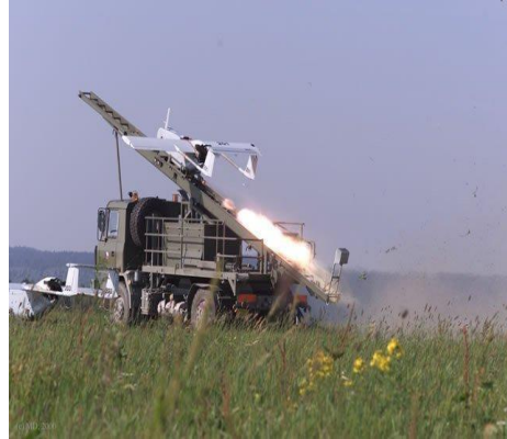
7. kép: Sojka UAV indítása rakétahajtással 27
