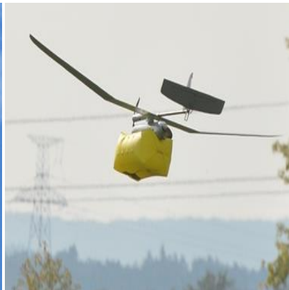
10. kép: A földet érés csillapítása légszákkal 31
