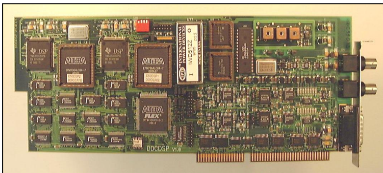
Vegyes fejlesztésű DDCDSP digitális jelfeldolgozó kártya
