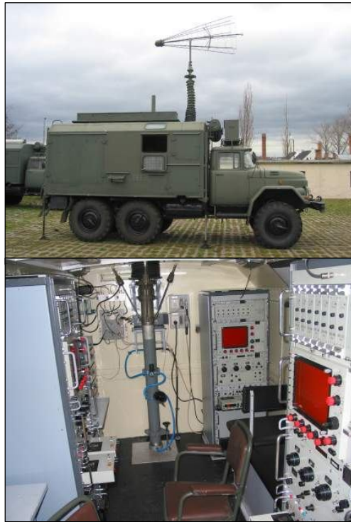
3. kép. Az URH RÁF-állomás (légi) telepítve és belső kialakítása 39
