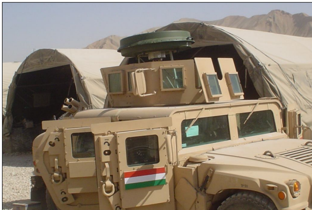
6. kép. Az R&S TMS 100 mobil SIGINT-készlet ideiglenes beépítése egy katonai járműbe Afganisztánban (Fotó: Balogh Péter, 2008)
