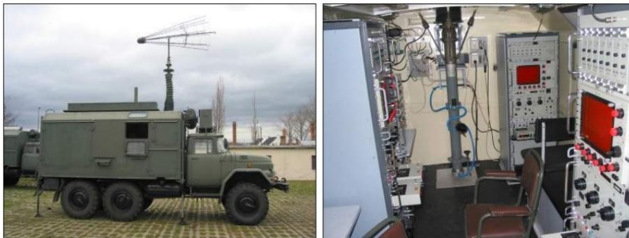
1. ábra. URH/L RÁF-állomás és belső felépítése 15
