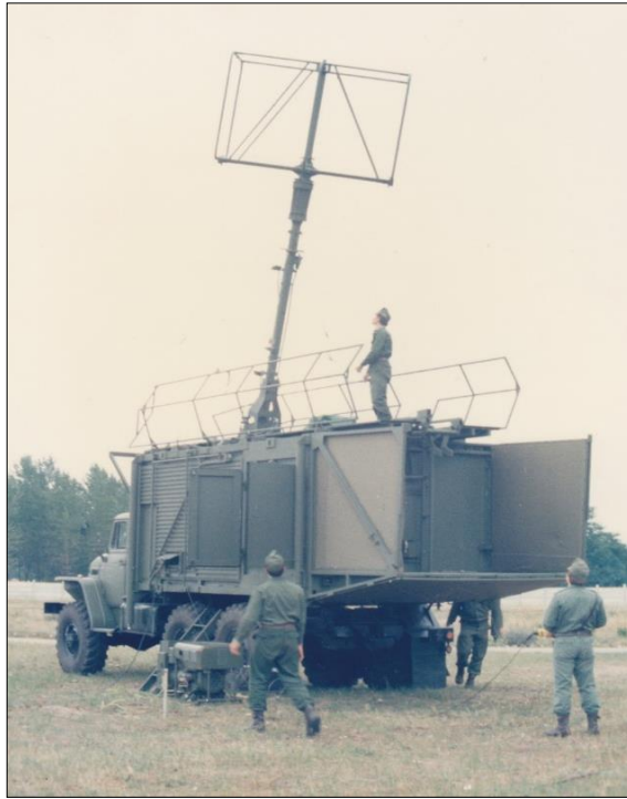
R-1301 rövidhullámú iránymérő állomás
