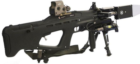
10. kép: REX- 1 elektromágneses zavaró eszköz kimondottan drónok elleni használatra 27
