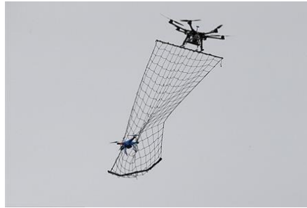
7. kép: Drón elfogása drónra rögzített hálóval 11
