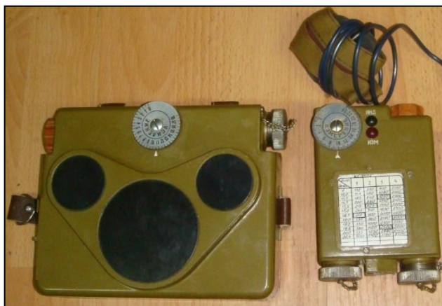
5. ábra. ERRSz-1 rádiótechnikai felderítőkészülék 25
