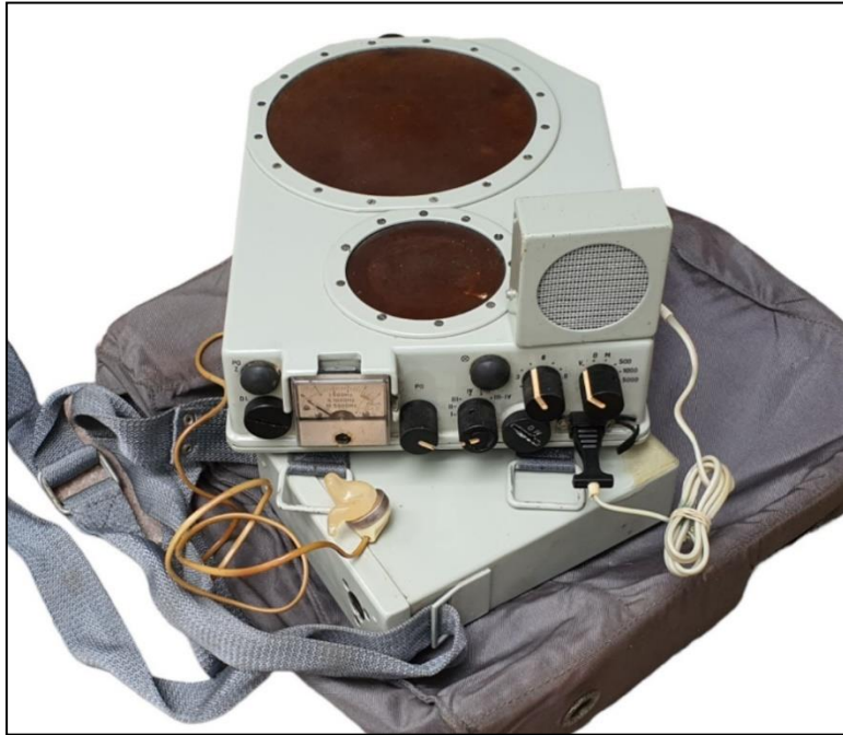
4. ábra. MRP–4 kis méretű rádiótechnikai felderítőkészülék, néhány alapvető tartozékkal (a két barna, kör alakú rész alatt a beépített antennák vannak) 23
