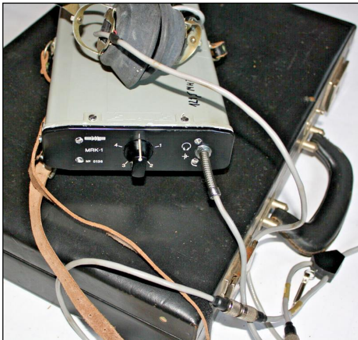
6. ábra. MRK–1 kézi iránymérő vevőkészülék (a ledek takarásban vannak) 31
