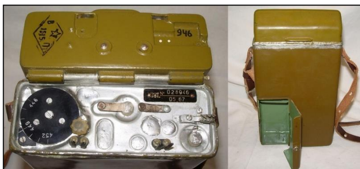
2. ábra. R–254 vevőkészülék felnyitott fedéllel és kinyitott akkumulátorrekesszel (a fejhallgató hiányzik a fényképen látható készülékről) 14
