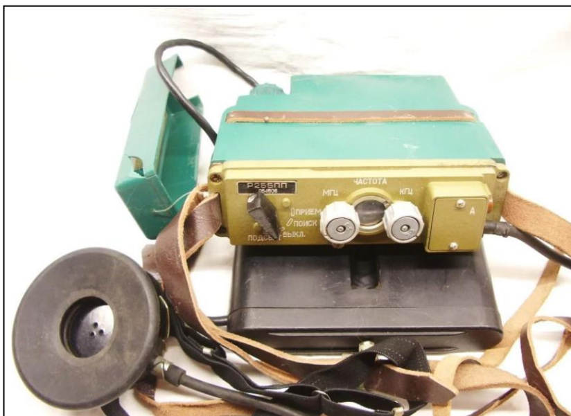
3. ábra. R–255PP kereső vevőkészülék (az alatta lévő fekete műanyag doboz az opcionális külső tápellátást biztosította) 20
