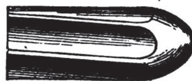
13. Whitworth huzagolás metszete és lövedék
