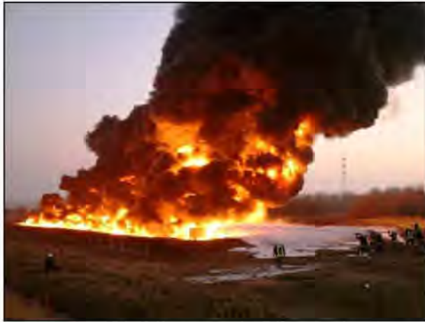
28. fénykép: Habterjedési kísérlet nehézhabbal; Forrás: FER Tűzoltóság
