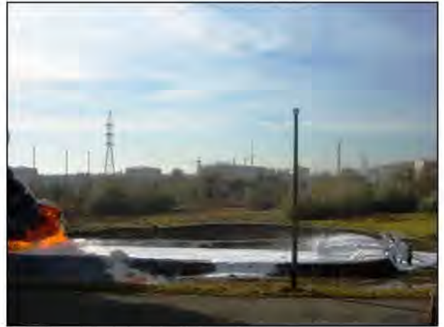
29. fénykép: Habterjedési kísérlet középhabbal; Forrás: FER Tűzoltóság
