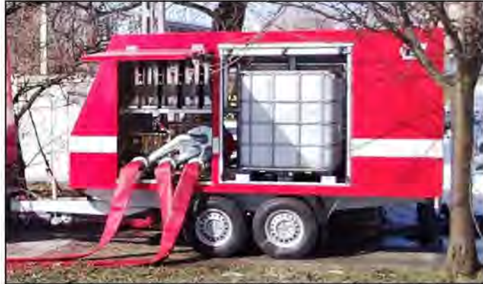
20. fénykép: Utánfutóra épített FireDos 10000-09S1-02 habbekeverő rendszer
