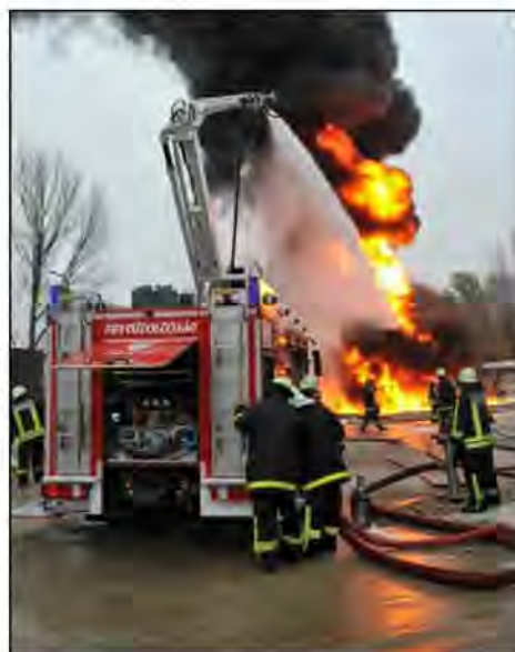
11. fénykép: Oltókarra épített Hydro-Chem ágyú; Forrás: FER Tűzoltóság
