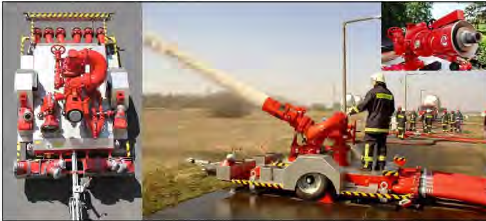
11. ábra: Alco APF 8-HR ágyú. Készítette: a szerző, 2013.
