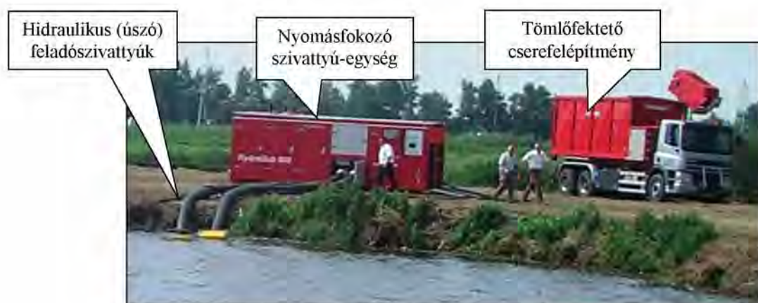
20. ábra: HFS nagyteljesítményű mobil tűzi-víz ellátó rendszer
