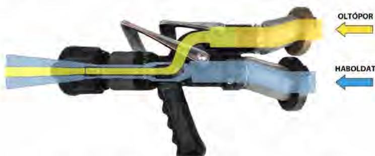
9. ábra: Hydro-Chem kézi sugárcső működése [57]
