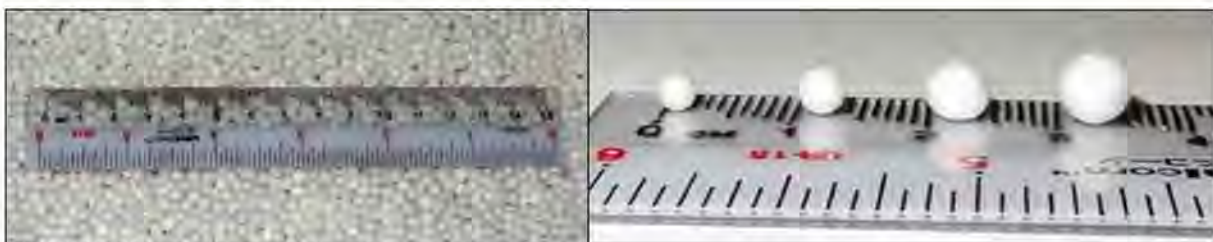
15. fénykép: DryFoam gyöngyök; készítette a szerző, 2016.
