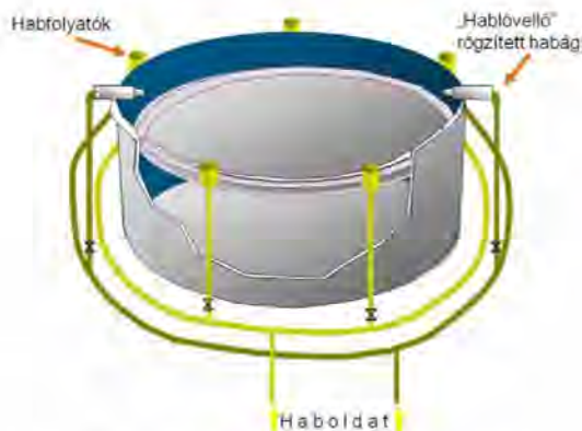
44. ábra: Tipikus habrendszer kialakítás beépített hablövellő ágyúkkal [108]
