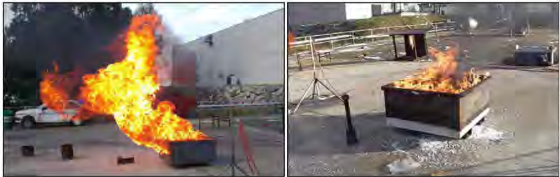
18. és 19. fénykép: LNG tűz intenzitásának csökkentése DryFoam alkalmazásával [68]
