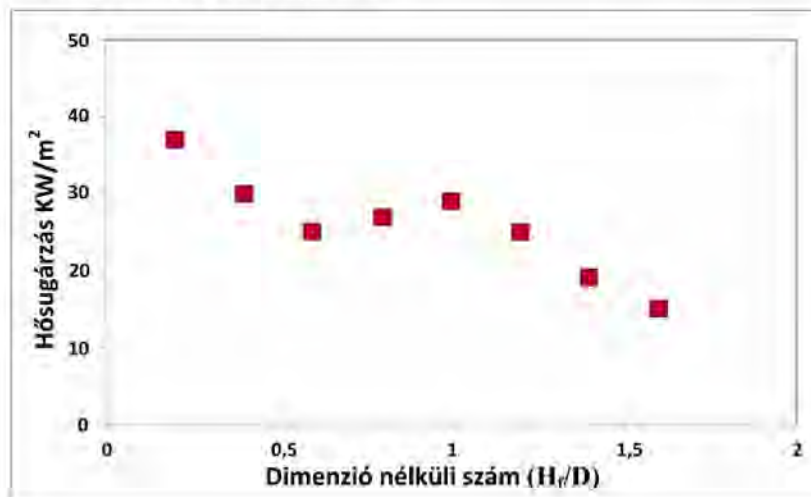
40. ábra: A lángtér középvonalának átlagos hősugárzás kibocsátása és a lángmagasság/tartályátmérő arányszám összefüggése [35]
