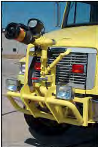
13. fénykép: Ranger Hydro-Chem ágyú gépjárműre építve [57]
